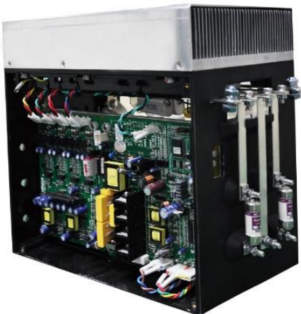
Силовой блок инвертора
